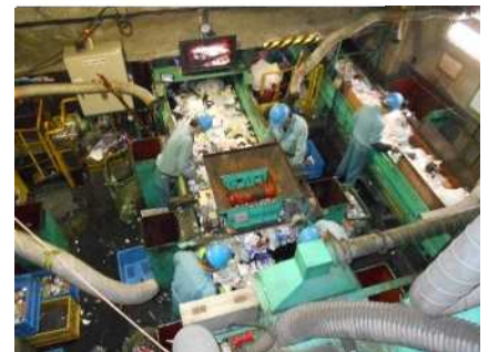
プラスチックの選別作業の様子
