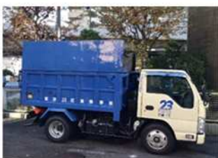
④小型ダンプ車 粗大ごみの運搬に使用しています。
