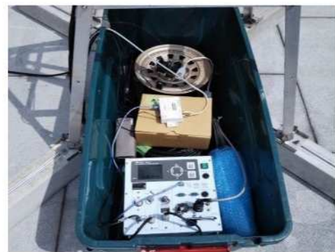
航空機騒音観測装置
