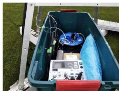
航空機騒音観測装置
