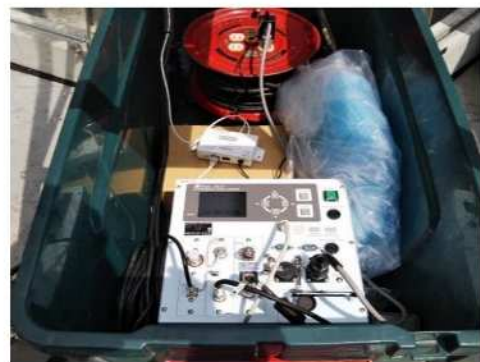
航空機騒音観測装置
