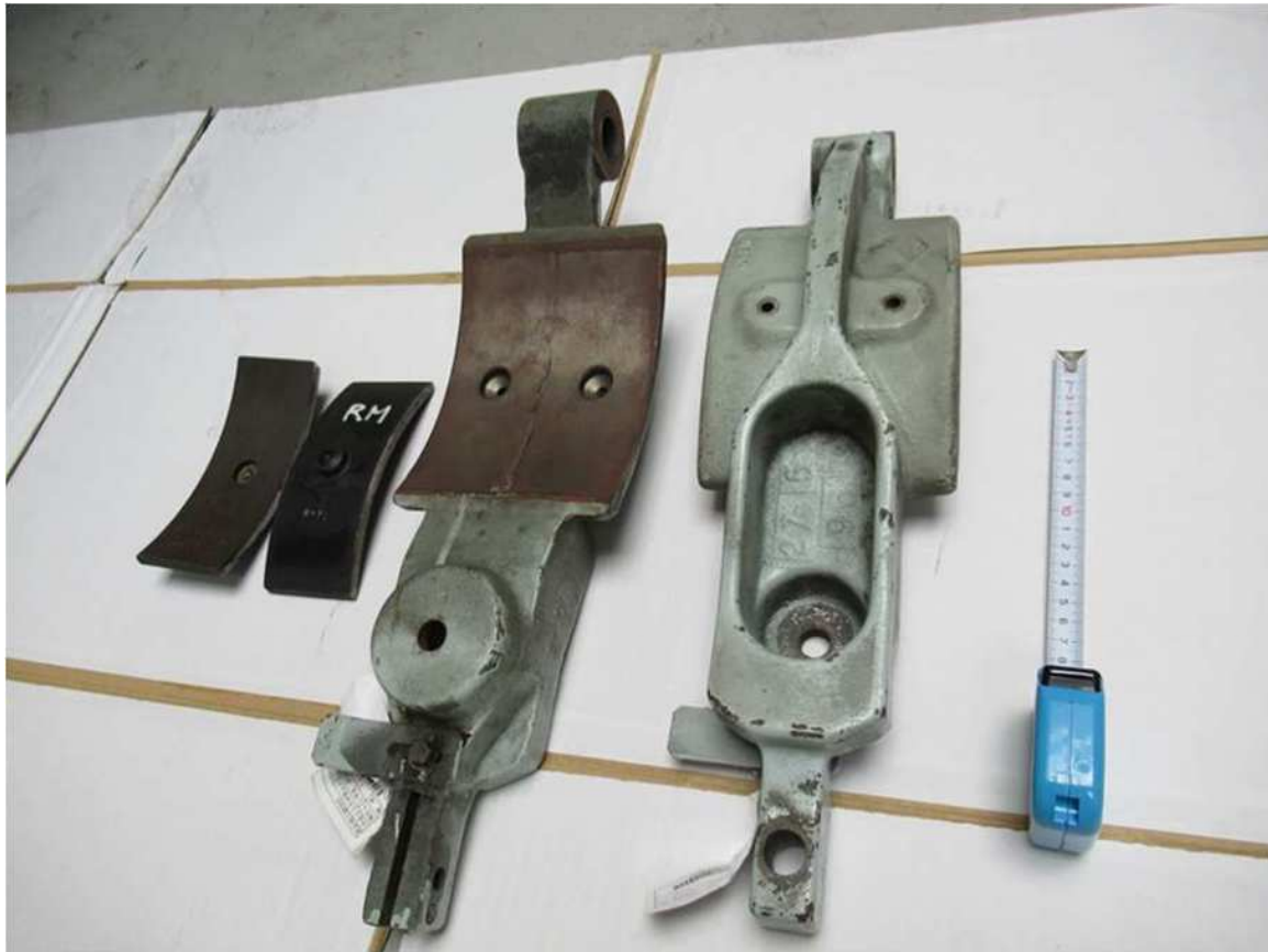
▲写真5 ブレーキアームおよびブレーキパッドの一部
