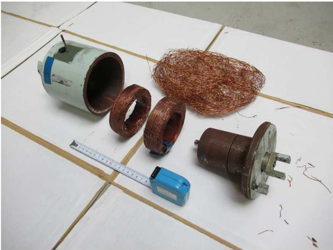
▲写真4 ソレノイド（コイルが切断され、分解された状態：事故機部品）
