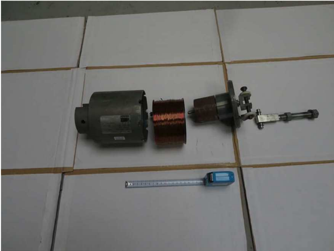
▲写真3 ソレノイド（コイルが切断されていない状態：事故機同型機の部品）
