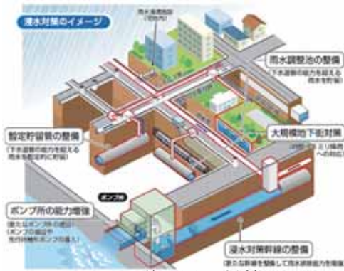
下水道の浸水対策
