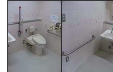
【Fig. 10】デイルーム内車椅子便所
