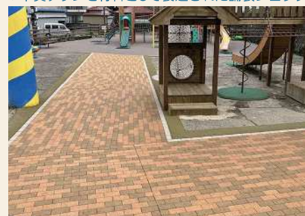
▼木質チップを材料として製造された舗装ブロック
